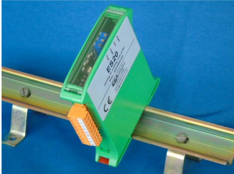
Il convertitore di segnale ES20 trasforma la tensione tra 0 e 10 Volt applicata in ingresso in una tensione in uscita adatta al comando di una elettrovalvola oleodinamica proporzionale bidirezionale.
